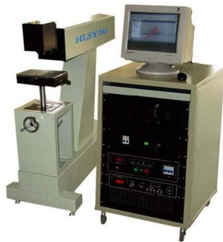
图 8 典型的振镜式 YAG 激光打标机
