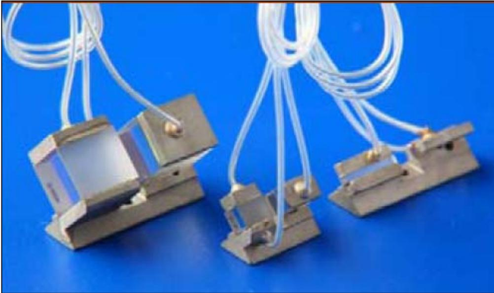
RTP（磷酸钛氧铷）晶体属 KTP 族晶体，因其良好的电学与光学性能，包括较高的电阻率（约  $10^{11}$ - $10^{12} \Omega \cdot \text{cm}$  和抗光伤阈值，非常适合用做电光器件，如激光 Q 开关、快门、相位和振幅调制器、脉冲选择器，腔倒空器和偏转器。
