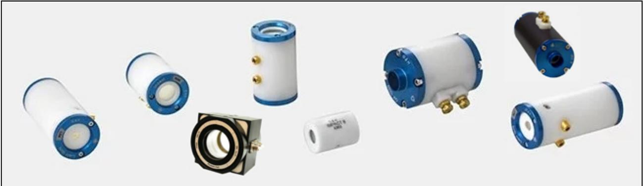
电光调 Q 是指在激光谐振腔内加置一块偏振片和一块 KD\*P 晶体。光经过偏振片后成为线偏振光，如果在 KD\*P 晶体上外加  $\lambda/4$  电压，由于泡克尔斯效应，使往返通过晶体的线偏振光的振动方向改变  $\pi/2$ 。如果 KD\*P 晶体上未加电压，往返通过晶体的线偏振光的振动方向不变。所以当晶体上有电压时，光束不能在谐振腔中通过，谐振腔处于低 Q 状态。由于外界激励作用，上能级粒子数便迅速增加。当晶体上的电压突然除去时，光束可自由通过谐振腔，此时谐振腔处于高 Q 值状态，从而产生激光巨脉冲。电光调 Q 的速率快，可以在 10-8 秒时间内完成一次开关作用，使激光的峰值功率达到千兆瓦量级。如果原来谐振腔内的激光已经是线偏振光，在装置电光调 Q 措施时不必放置偏振片。我们的电光 Q 开关产品全，质量高，开关速度快，调 Q 频率高达 MHz 以上，使用寿命超过两年，是国际上最好的电光 Q 开关。
